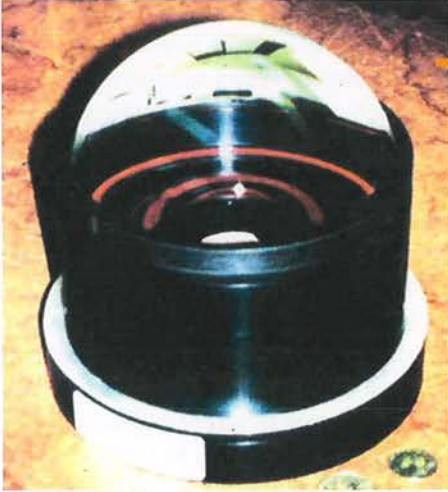
Ryc. 32. Szerokokątna kamera CCD F/1 zamontowana na teleskopie anglo-australijskim
