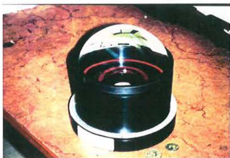
Ryc. 7. Nowatorska szerokokątna kamera CCD F/1, którą skonstruowaliśmy dla umieszczenia na anglo-australijskim 4-metrowym teleskopie (AAT) w celu obserwacji wystarczająco dużego obszaru nieba i poszukiwania supernowych typu Ia o przesunięciu ku czerwieni z > 0,3 w setkach galaktyk równocześnie
