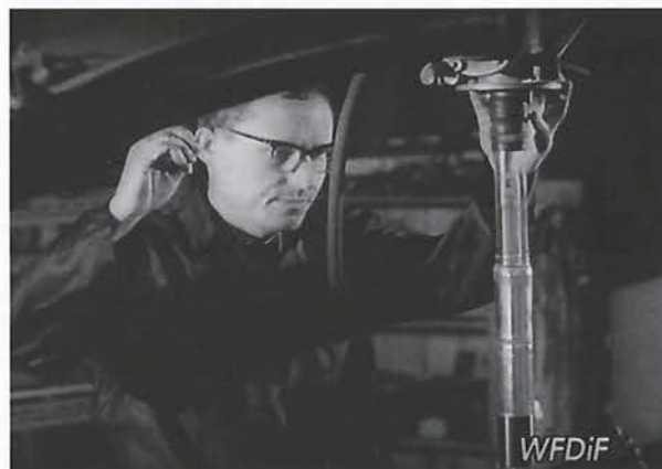
Fot. 3. Czesław Bazan przy kriostacie do rozmagnesowania adiabatycznego. W górnej części zdjęcia widoczna jest szeroka rura prowadząca do dużej rotacyjnej pompy próżniowej obniżającej temperaturę kąpeli helowej do 1,2 K. Serwis YouTube, Polska Kronika Filmowa 19B/65
