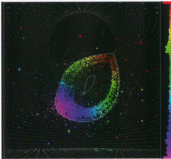
Rys. 1. U góry: zdjęcie wnętrza detektora Super-Kamiokande używanego przez eksperyment T2K. Na ścianach detektora widać zamontowane fotopowielacze. U dołu: komputerowo wykonana wizualizacja oddziaływania neutrina w detektorze Super-Kamiokande. Zarejestrowany pierścień pochodzi od światła powstającego w zjawisku Czerenkowa wyemitowanego przez mion powstały w wyniku oddziaływania neutrina mionowego w wodzie
