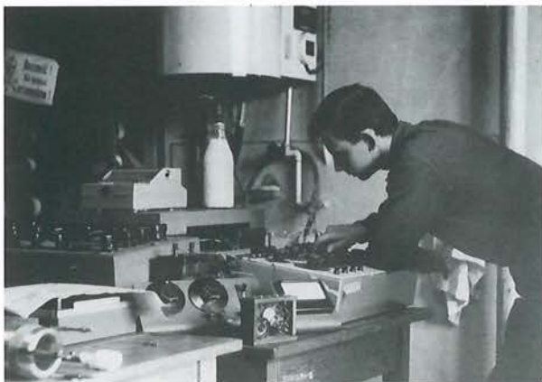
Fot. 3. Autor artykułu podczas pomiarów w pracowni Czesława Bazana, rok 1966. Widoczne jest wyposażenie pracowni: jasny, duży zbiornik to destylator wody przeznaczanej do chłodzenia magnezu, po lewej stronie widać odłączniki silnopiętrowe zasilania magnezu, na stołach znajdują się mierniki analogowe, kompensatory prądu stałego do pomiaru niskich napięć, szklany akumulator kwasowy 2 V zasilający kompensator, galwanometry skrzynkowe, różne samodzielnie wykonane układy elektryczne oraz deputatowa, codzienna butelka mleka za pracę w warunkach szkodliwych dla zdrowia
