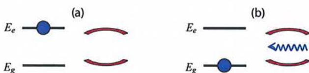
Rys. 2. (a) schematycznie przedstawiony atom wzbudzony do poziomu E_e i pusty rezonator. (b) Atom przeszedł do niższego stanu E_g , wysyłając foton, który został zmagazynowany w rezonatorze
