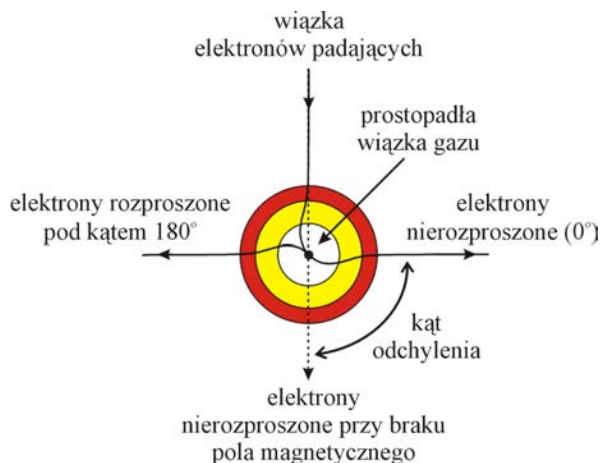
Rys. 3. Tory elektronów w źródle lokalnego pola magnetycznego [21]
