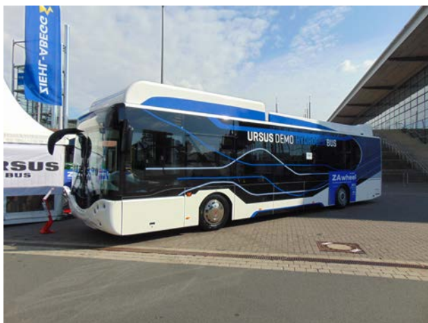
Ryc. 3. Polski miejski autobus Ursus City Smile Fuel Cell Electric Bus napędzany przez wodorowe ogniwa paliwowe (dzięki uprzejmości Ursus SA)
