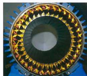
Fot. 2. Prądnicca synchroniczna 3-fazowa (4 kW, 375 obr./min, 50 Hz)
