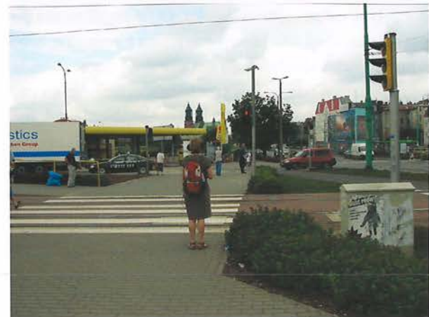
Fot. 2. Rejestracja „ścieżek dźwiękowych” za pomocą mikrofonów dousznych umieszczonych na głowie osoby poruszającej się z białą laską. Układ rejestrujący znajduje się w plecaku
