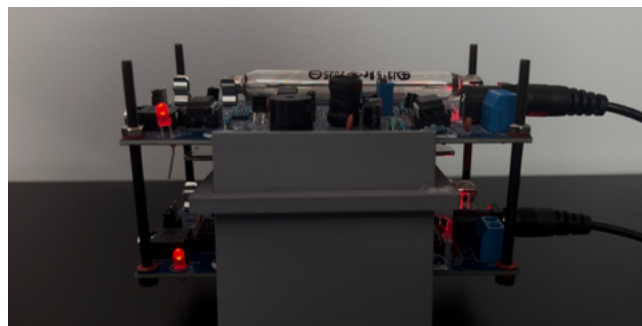
Rys. 2. Urządzenie wykrywające mion – świecą się obie diody. W przypadku wykrycia promieniowania ziemskiego tła, zaświeci się jedynie jedna dioda.
