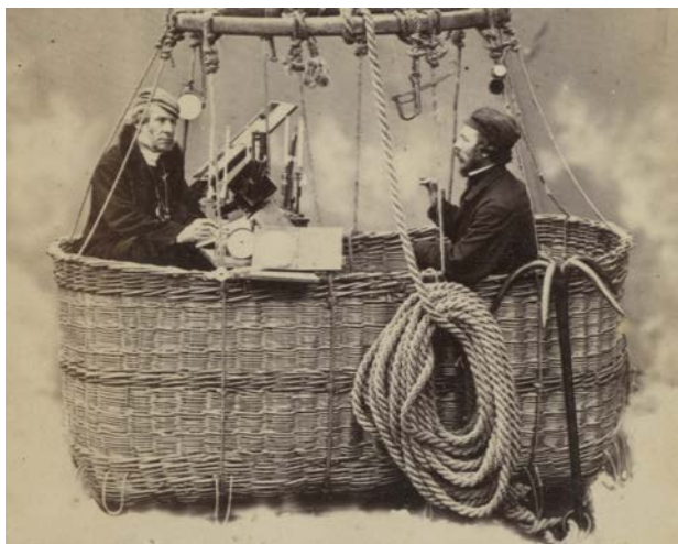
Ryc. 2. James Glaisher i Henry Coxwell z aparaturą w wiklinowym koszu balonu. Kotwicy używano przy lądowaniu, aby uniknąć wleczenia i rozbicia kosza [4]
