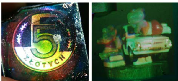
Ryc. 4. Przykładowe hologramy odtwarzające obraz barwny autorstwa studentów Wydziału Fizyki PW; hologramy zostały naświetlone trzema wiązkami laserowymi o barwach składowych: czerwonej, zielonej i niebieskiej (fot. M. Makowski)
