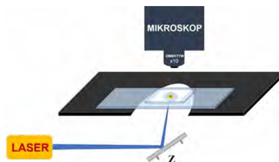
Rys. 1. Schemat układu pomiarowego i komórki pomiarowej: roztwór pNA w 1,4-dioksanie umieszczony jest pomiędzy dwoma szkiełkami mikroskopowymi oddalonymi od siebie przekładką (dystanserem) o kołowym kształcie. Sterowanie wiązką odbywa się za pomocą zwierciadła Z, a obserwacje dokonywane były pod mikroskopem polaryzacyjnym z obiektywem o powiększeniu 10
