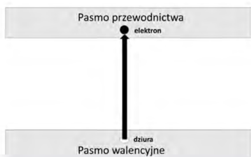
Rys. 1. Schemat procesu wzbudzenia pasmo-pasmo
