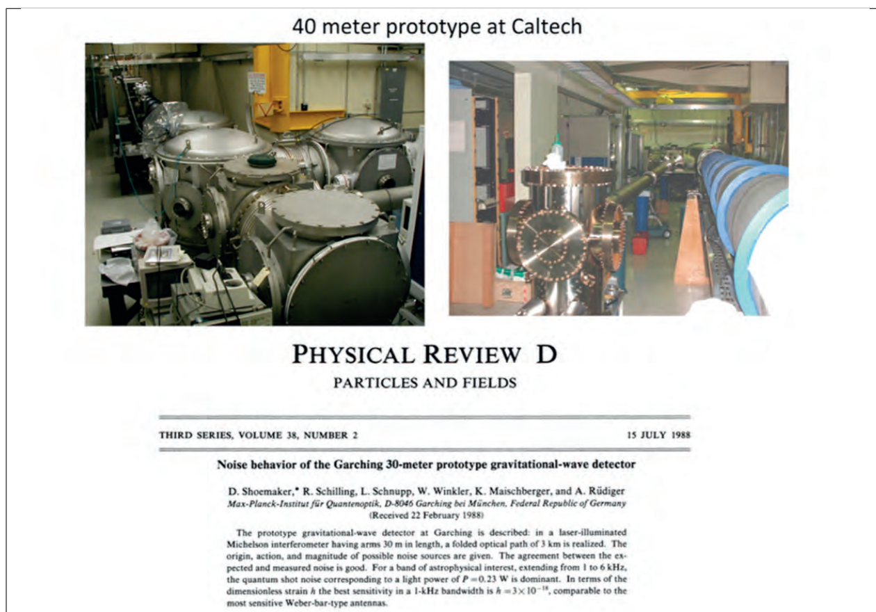
Ryc. 8. Abstrakt pracy przedstawiającej trzydziestometrowy interferometr grupy z Max Planck Institute of Astrophysics w Garching. W pracy pokazano, że interferometr ten osiągnął lepszą czułość niż najlepsze kriogeniczne cylindryczne detektory Webera. Osiągi tego trzydziestometrowego interferometru były bardzo pomocne przy naukowym uzasadnianiu budowy instrumentów o długiej bazie, takich jak LIGO. Dwie fotografie u góry pokazują czterdziestometrowy instrument zbudowany w Caltechu (California Institute of Technology) przez Whitcoma i Drevera. Interferometry: czterdziestometrowy Caltechu i pięciometrowy zbudowany w MIT (pokazany na ryc. 13) były ostatnimi testowymi instrumentami przed zbudowaniem pierwszego detektora LIGO.
