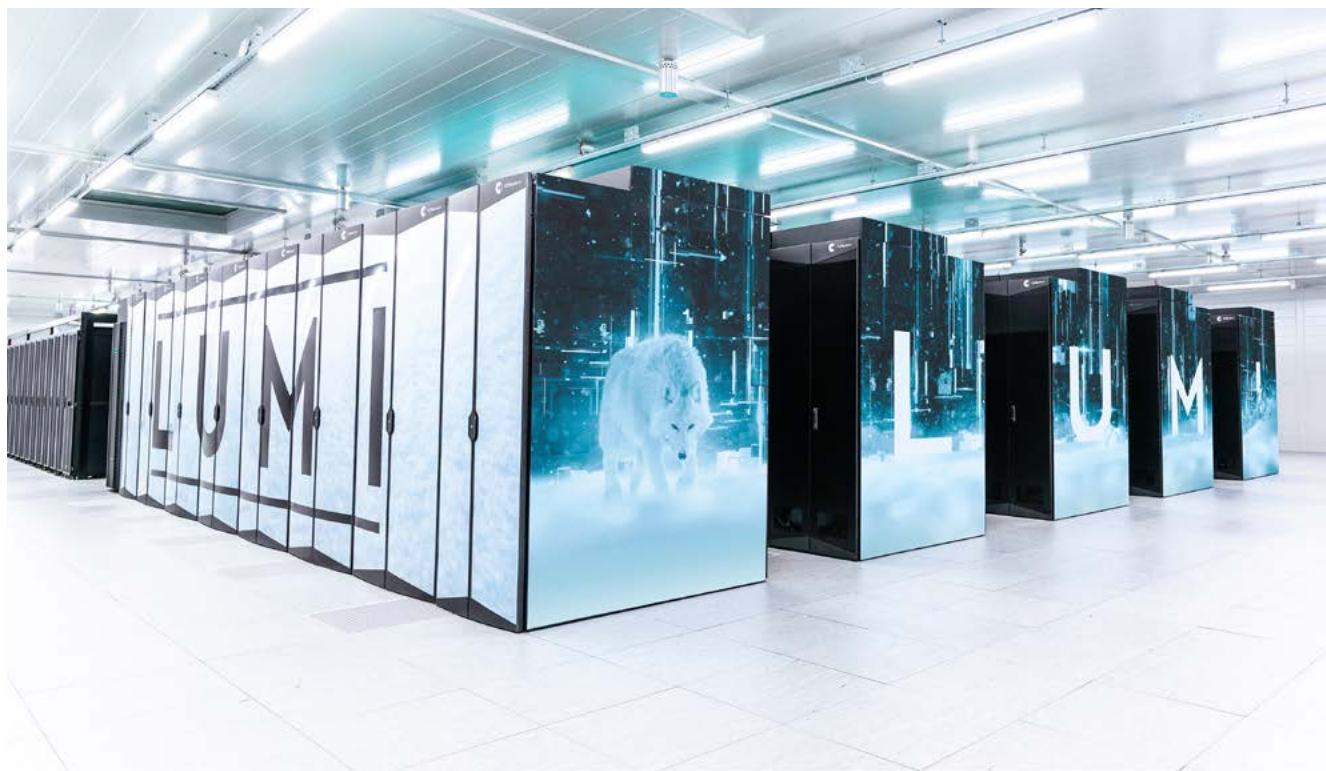
Rys. 1. LUMI: superkomputer EuroHPC klasy przedeksaskalowej należący do najpotężniejszych systemów obliczeniowych na świecie. Jego podstawowym elementem są węzły obliczeniowe wyposażone w akceleratorzy graficzne AMD Instinct MI250X. Każdy węzeł GPU zawiera jeden procesor CPU AMD EPYC oraz cztery karty graficzne MI250X. Każda z tych kart składa się z dwóch niezależnych układów obliczeniowych, co oznacza, że pojedynczy węzeł udostępnia łącznie osiem równoległych jednostek GPU do obliczeń naukowych. Cały system obejmuje ponad 2900 takich węzłów GPU połączonych ultraszybko siecią, co umożliwia ich kolektywną pracę przy rozwiązywaniu jednego, bardzo złożonego problemu.
