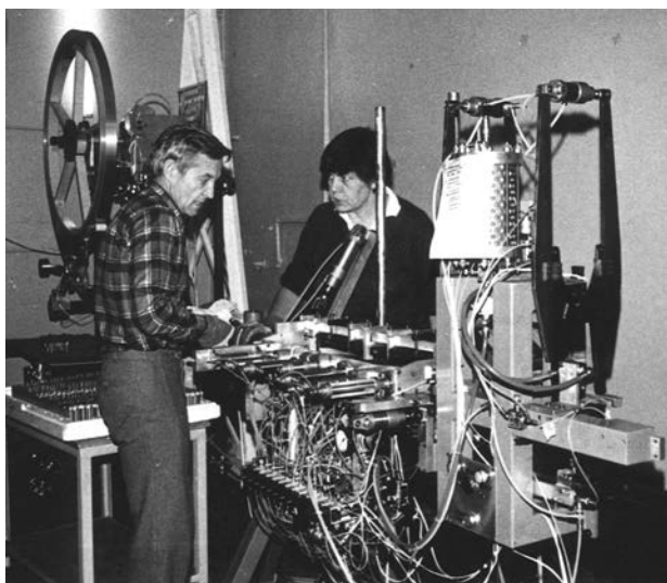
Ryszard Sosnowski w towarzystwie Marii Szeptyckiej z IPJ przy maszynie do produkcji taśmy z drutu ołowianego do kalorymetru elektromagnetycznego dla eksperymentu DELPHI (fot. Robert Mazurek, IFD UW 1987)
