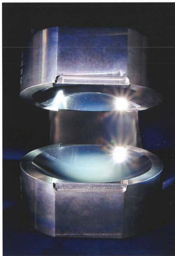
Rys. 8. Pudło dla fotonów z ENS (zdjęcie Michel Brune). Zwierciadła mają średnicę 5 cm i są od siebie oddalone o 2,7 cm (na zdjęciu odległość ta została zwiększona dla przejrzystości)
