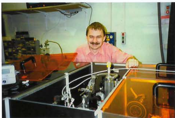
Ryszard Naskręcki przy femtosekundowym układzie do absorpcji przejściowej. CEA Saclay, 1997
