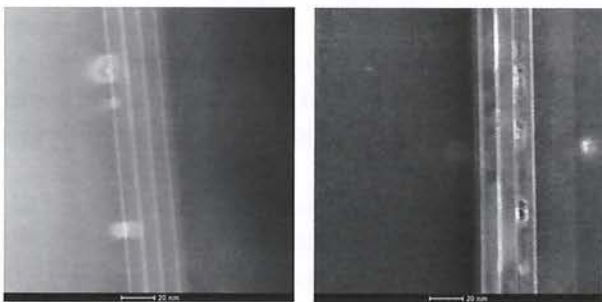
Rys. 4. Topografia transmisyjnej mikroskopii elektronowej (TEM) dla studni kwantowych InGaN (białe paski) z barierami GaN. Po lewej: przed nałożeniem typu p w wysokiej temperaturze. Po prawej: po nałożeniu typu p w wysokiej temperaturze
