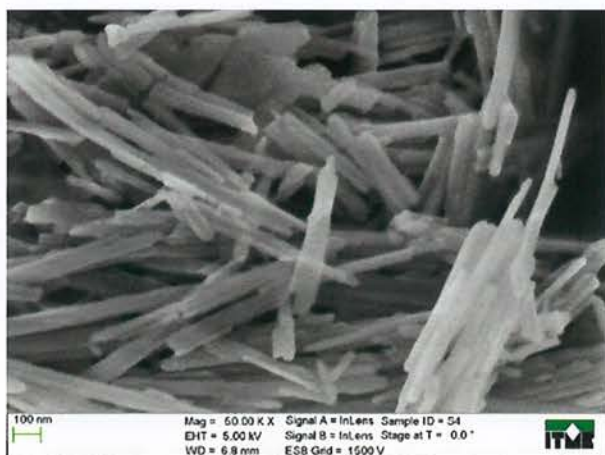
Rys. 4. Obraz SEM nanoproszku fluorku itru współdomieszkowanego erbem i itrem ( Y_2O_3:Er, Yb ) otrzymanego metoda hydrotermalna
