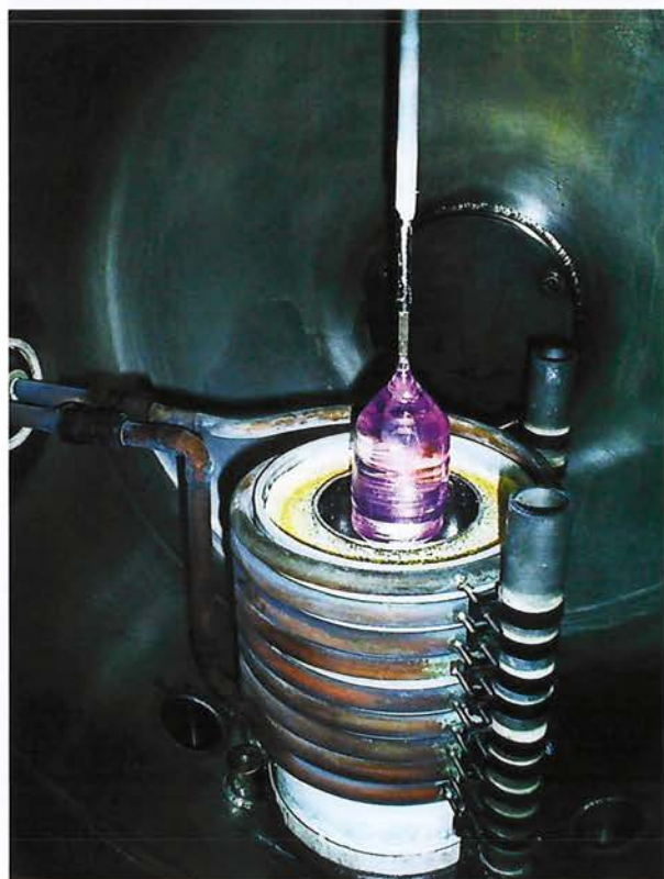
Fot. 6. Kryształ YAG-u (A) w cewce indukcyjnej i (B) widok kryształu w komorze urządzenia
