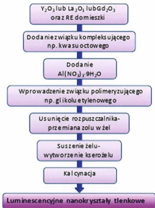
Rys. 2. Schemat zmodyfikowanej metody zol-żel do otrzymywania tlenkowych nanokrystalów: granatów i perowskitów domieszkowanych jonami ziem rzadkich
