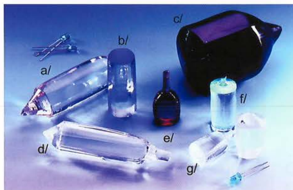
Fot. 7. Monokryształy tlenkowe otrzymane w ITME metoda Czochralskiego: a) \text{Al}_2\text{O}_3 (szafir); b) \text{Y}_3\text{Al}_5\text{O}_{12} domieszkowany iterbem (YAG:Yb); c) \text{NdGaO}_3 (NGO); d) \text{Y}_3\text{Al}_5\text{O}_{12} niedomieszkowany (YAG); e) \text{YVO}_4 domieszkowany Nd (YVO:Nd); f) \text{SrLaGa}_3\text{O}_7 (SrLaGa); g) \text{GdCa}_4\text{O}(\text{BO}_3)_3 (GdCOB)
