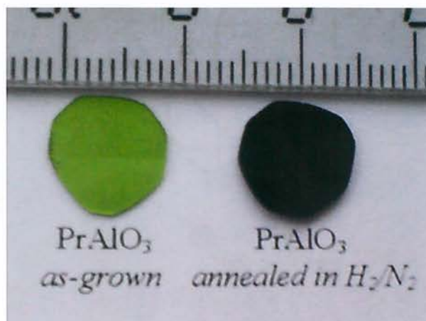
Fot. 8. Kryształ po procesie wzrostu i kryształ wygrzany w atmosferze redukującej ( \text{H}_2/\text{N}_2 )
