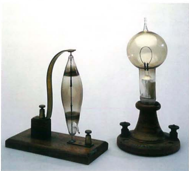
Rys. 18. Żarówka Edisona z dodatkową elektrodą stała się prototypem lamp elektronowych
