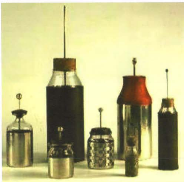
Rys. 8. Pierwsze zasobniki elektryczności – butelki lejdejskie
