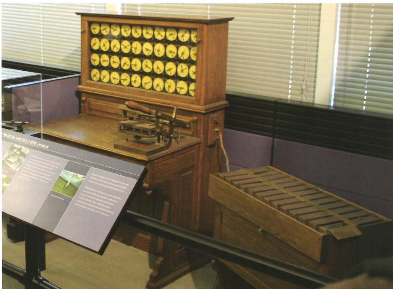
2. Maszyna do czytania kart perforowanych Hermanna Holleritha, użyta w spisie ludności USA w roku 1890. Na pulpicie stoi perforator, obok maszyny – pojemnik do magazynowania kart. Więcej objaśnień w tekście
