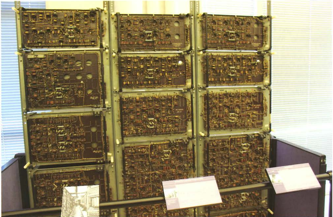
5. Moduł pamięci komputera Whirlwind I – pierwszego, w którym zastosowano pamięć magnetyczną. Jeden prostopadłościenny blok mieścił 1 kb.
