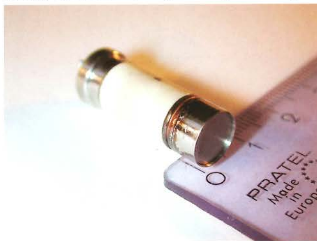
Rys. 7. Miniaturowa lampa firmy ThermoFischer Scientific stosowana do fluorescencji rentgenowskiej 22
