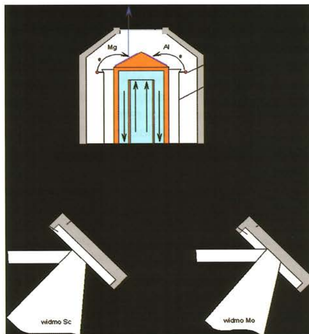
Rys. 6. Schematyczne przedstawienie działania anody (w górnej części rysunku – anoda bliźniacza, w dolnej części – anoda podwójna)
