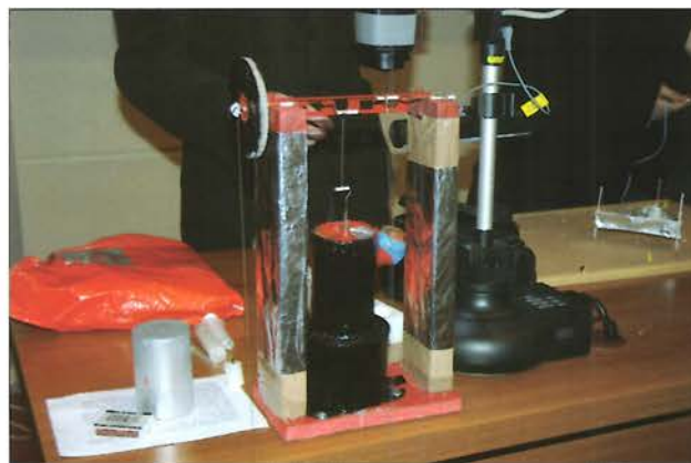
... i ich dzieło: domowej roboty silnik Stirlinga
