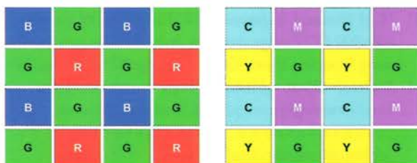
Rys 22. Układy filtrów barwnych, jakimi pokrywa się matrycę CCD w zastosowaniach jako kolorowego detektora światła. W aparatach cyfrowych używane są filtry RGB w układzie Bayera [30]. Alternatywnym układem jest układ czterokolorowy CMYG.
