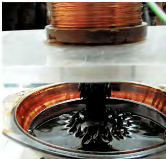
Jeż z cieczy ferromagnetycznej utworzony za pomocą pola magnetycznego (fot. OG PTF)
