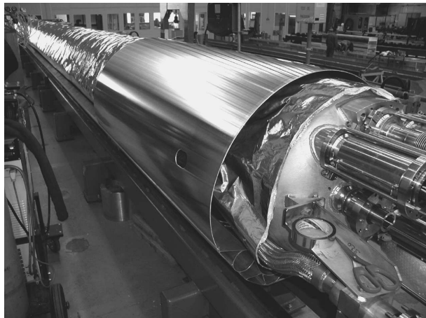
Rys. 9. Montaż ekranu termicznego wokół magnesu dipolowego
