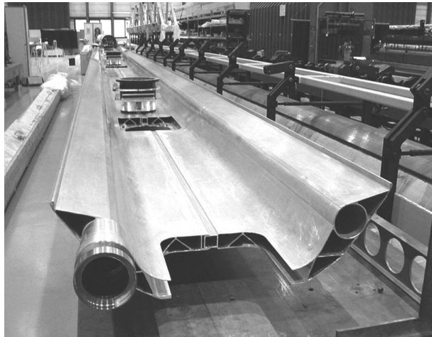
Rys. 10. Łoże magnesu dipolowego z przygotowanymi wspornikami (stopami) dla „zimnej masy”. Z lewej strony przepust dla chłodzącego gazowego helu.
