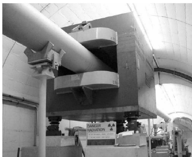
Rys. 3. Widok magnesu „wymiatającego” naładowane cząstki lecące razem z neutronami
