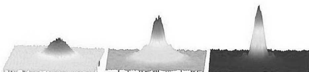
Rys. 10. Trójwymiarowe mapy rozkładów pędowych w przypadkach: chmury atomów termicznych ( T = 500 nK), przejścia fazowego ( T = 250 nK) i czystego kondensatu BE ( T < 70 nK)
