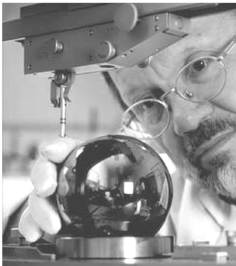
Rys. 3. Najdoskonalsza materialna kula na świecie (monokryształ krzemu). Według australijskiej firmy, która wyhodowała monokryształ i go obrobiła, powiększenie kuli do rozmiarów Ziemi dałoby nierówności powierzchni o maksymalnej wysokości 4 metrów [10].
