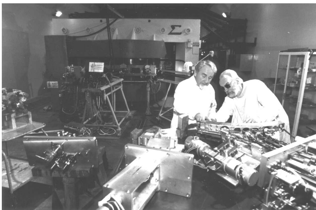
Elementy układu ekstrakcji wiązki jonów cyklotronu AIC-144 przed zainstalowaniem; przy aparaturze mgr inż. Bakewicz (z lewej) i dr Taraszkiewicz
