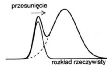
Rys. 13. Błąd popełniany w określaniu położenia dalszych maksimów. W wyniku nałożenia się dwóch blisko leżących rozkładów Gaussa odczytane położenie wypadkowego rozkładu jest przesunięte względem rzeczywistego. Może to tłumaczyć trudności w dobraniu odpowiedniej wartości oporu resztkowego równocześnie dla wszystkich trzech maksimów.
