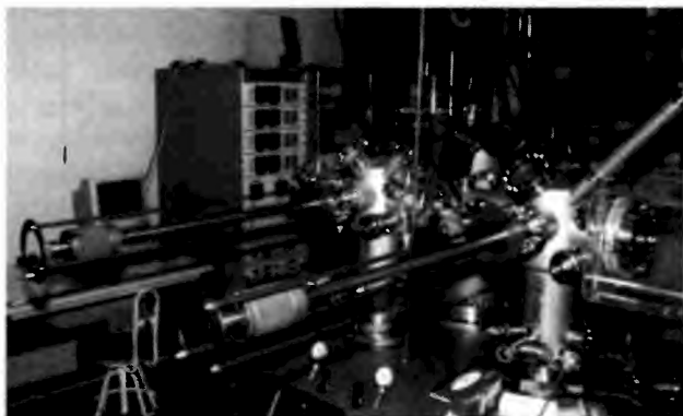
Rys. 1. Reaktor do epitaksji z wiązek molekularnych zainstalowany w ITE
