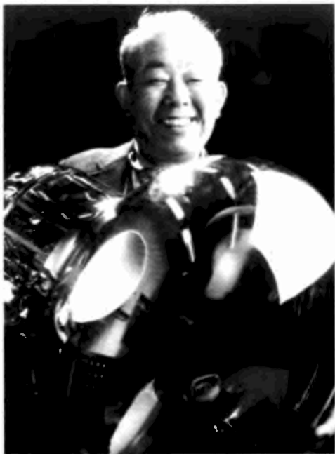
Rys. 2. Duży fotopowielacz skonstruowany specjalnie dla KamiokaNDE.
