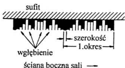
Rys. 4. Dyfuzor fazowy polepszający rozkład kątowy promieni dźwiękowych, oparty na resztach kwadratowych liczb naturalnych 1, 2, 3, \dots modulo liczba pierwsza 17. Zagłębienia w suficie, które powtarzają się z okresem 17, wzbudzają oczekiwane przesunięcie fazy fali padającej, co prowadzi do tego, że energia dźwięku odbitego ulega rozproszeniu w szerokim kącie.
