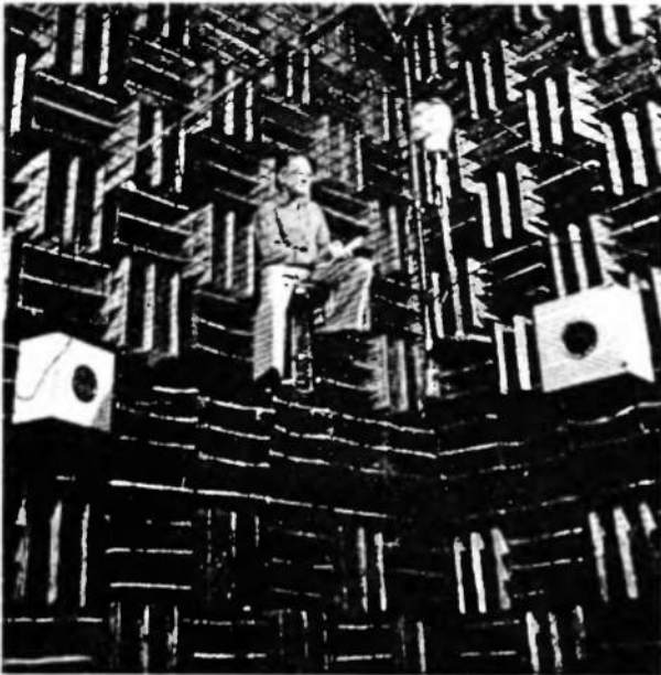
Rys. 1. Autor w kabine bezchowej Laboratorium Bella w czasie pomiarów własności akustycznych sztucznej głowy, zaprojektowanej w Instytucie Fizyki III w Getyndze. Sztuczna głowa jest używana w nagraniach dźwięku realizowanych w rzeczywistych salach koncertowych (zdjęcie: Bell Laboratories).
