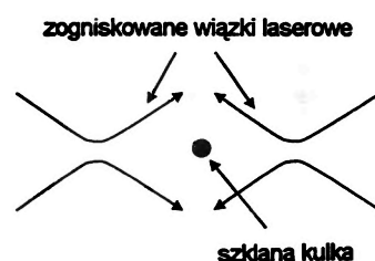
Rys. 2. Schemat pierwszej pułapki, skonstruowanej przez Ashkina. Uwięzienie w kierunku osiowym wynika stąd, że siły rozproszeniowe pochodzące od wiązek nadbiegających z lewej i prawej nie równoważą się. Uwięzienie w kierunku radialnym jest rezultatem działania siły dipolowej, która musi pokonać skierowaną na zewnątrz siłę rozproszeniową.
