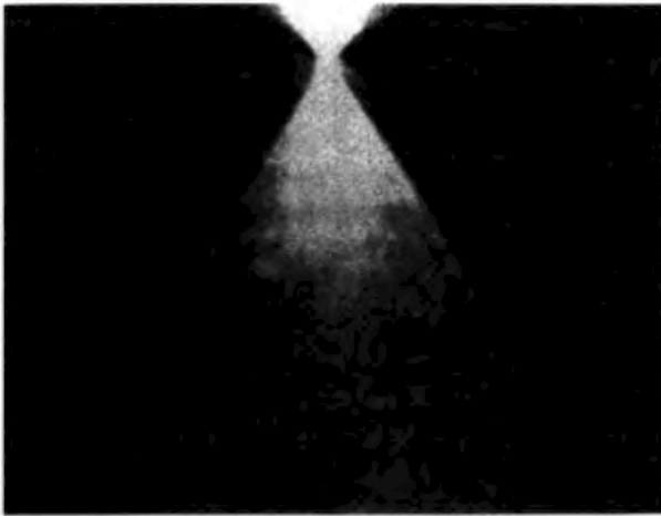
Rys. 1. Fotografia szklanej kulki o średnicy 10\ \mu\text{m} uwięzionej w wodzie za pomocą wiązki lasera argonowego padającej z góry. Fluorescencja jest rejestrowana przy użyciu filtra przepuszczającego światło czerwone, a zatrzymującego zielone. Promienie wychodzące (załamane) wykazują znaczące zmniejszenie kątów względem promieni padających. Wzrost pędu światła skierowany do przodu daje siłę działającą na szklany paciorek, skierowaną do góry. Siła ta równoważy skierowaną w dół siłę rozproszeniową. Prążki widoczne w świetle rozproszonym do przodu są zwykłym wzorem pierścieniowym, charakterystycznym dla rozpraszania Miego.
