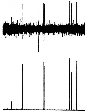
Porównanie konwencjonalnej rekonstrukcji fourierowskiej z rekonstrukcją Max.Ent. (dół) w widmie jądrowego rezonansu magnetycznego
