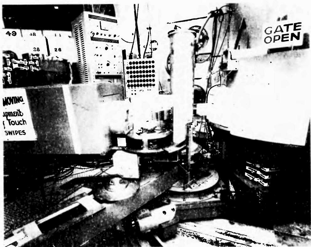
Rys. 9. Fotografia (z 1959 r.) spektrometru przy reaktorze NRU w Chalk River. Nieco powyżej środka rysunku widać zestaw 52 przeliczników obrotowych, które pozwalały na przemiatanie poprzez 26 wartości przekazu energii. Jedna z trzech wchodzących w grę zmiennych jest w zadanym przedziale wartości zmieniana liniowo, czemu odpowiadają nieliniowe zmiany dwóch pozostałych, zgodnie z ustawieniem odpowiednich przeliczników (fot. AECL).
