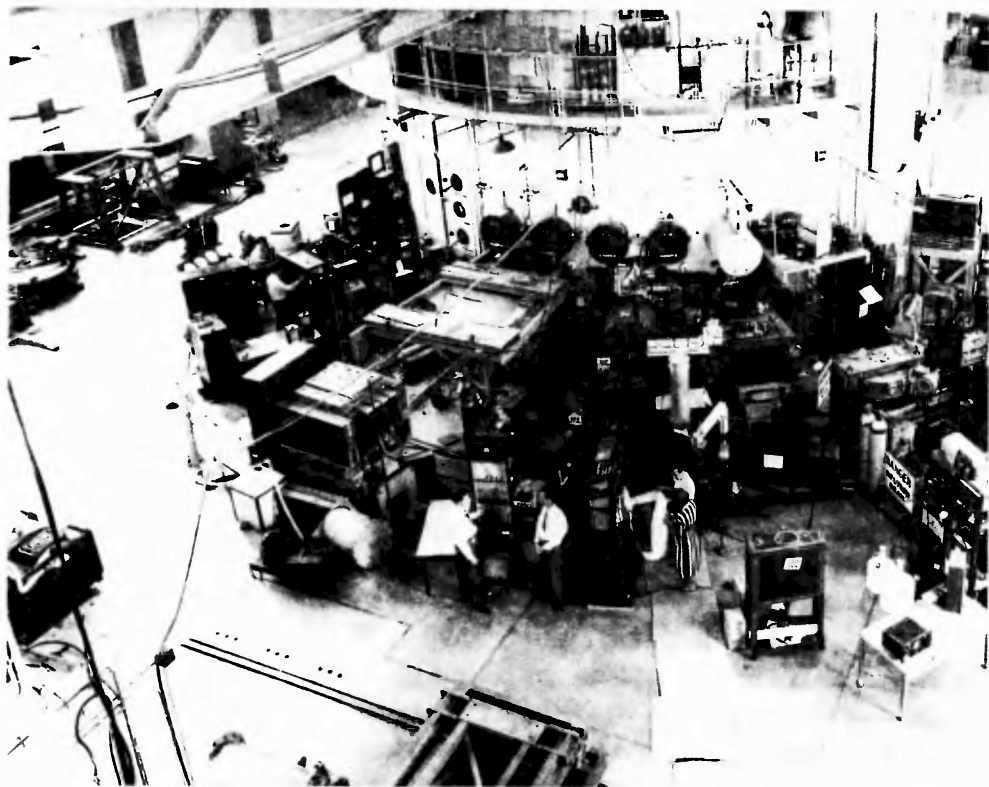
Rys. 1. Hala pomiarowa reaktora NRX przy Laboratorium Chalk River, około 1950 r. W pobliżu środka fotografii widać dyfraktometr proszkowy zbudowany przez Donalda Hursta i in. Pozostałe urządzenia związane są głównie z fizyką jądrową lub z fizyką neutronu jako takiego. Aby wszystko się zmieściło, każda aparatura ustawiona jest na końcu długiej rury (fot. AECL).
