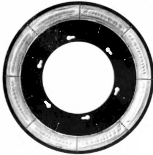
Rys. 1. Koło tarczowe z ośmioma identycznymi tarczami zamontowanymi na jego obrzeżu
