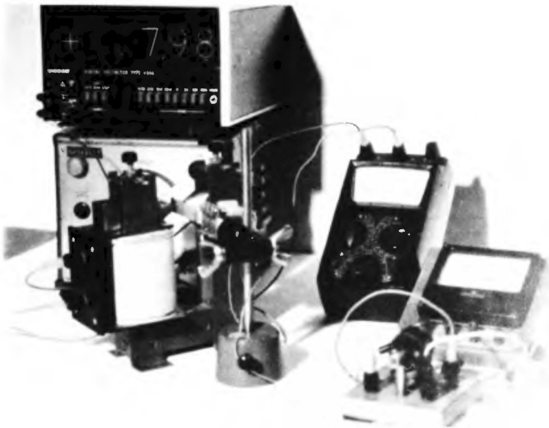
Fot. 1. Układ eksperymentalny do pomiaru efektu Halla przygotowany w Pracowni Pokazów Doświadczalnych Nauczycielskiego Kolegium Fizyki
