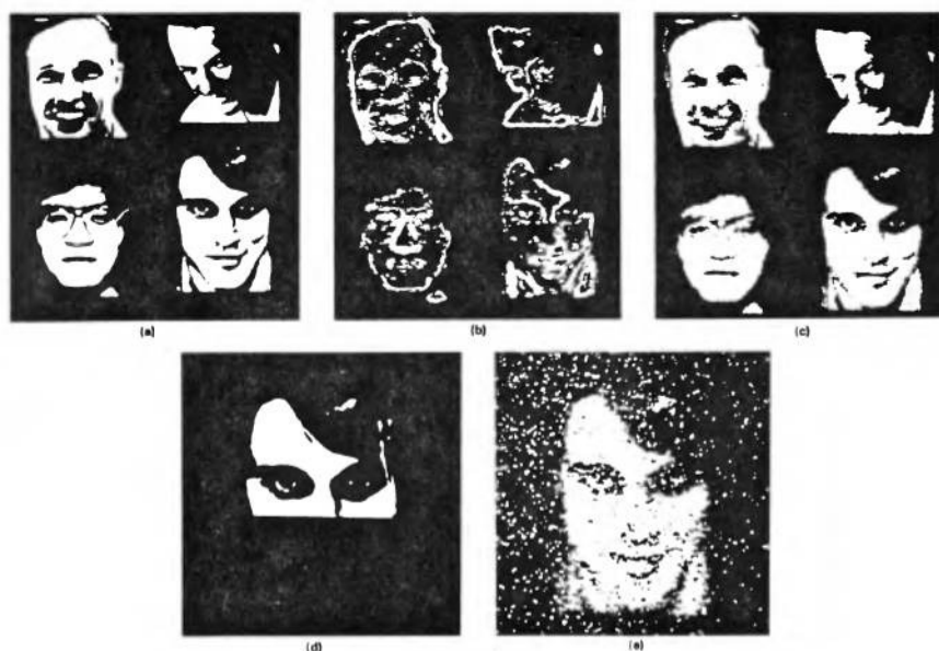
Rys.14. Wynik eksperymentu optycznego: a) cztery obrazy zapamiętywane przez hologram, b) wersja zapisana na pierwszym hologramie, c) wersja zapisana na drugim hologramie, d) obraz odczytujący, e) obraz odtworzony
