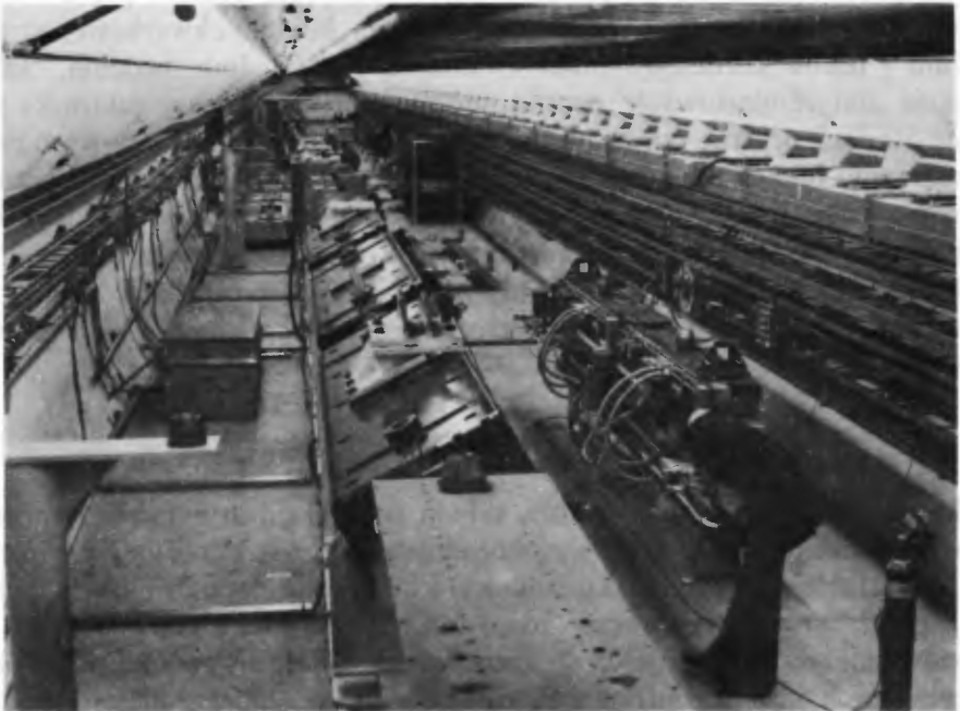
Rys. 1b. Widok tunelu wiązki neutrinowej przy SPS w CERN-ie w 1976 r., zanim uruchomiono urządzenie. W środku widoczna jest linia wiązki wąskopasmowej (NBB); po prawej stronie znajduje się transformator impulsowy rogu Van der Meera wiązki szerokopasmowej (WBB); sam róg, przeznaczony do ustawienia na podwyższeniu z lewej strony, nie jest jeszcze zainstalowany. W głębi widać okienko tytanowe o średnicy 2,5 mm obszaru próżniowego, w którym mają zachodzić rozpady. Fot. PHOTO CERN
