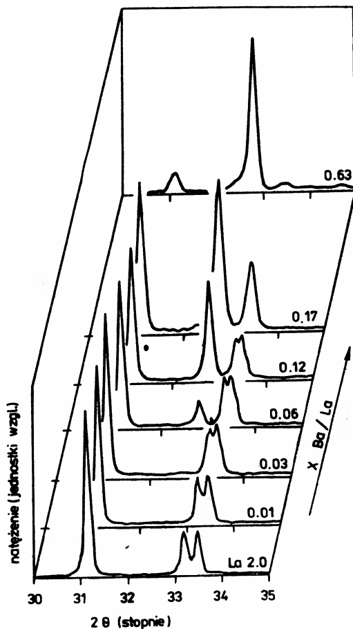
Rys. 1.8. Charakterystyczny fragment dyfraktogramu pokazujący przejście fazowe od struktury rombowej do tetragonalnej podczas zwiększania stosunku Ba : La. Oś koncentracji nie w skali. [1.20] © Pergamon Journals Ltd.
