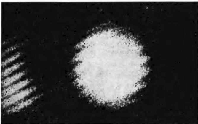
Rys. 10. Obraz drgań walca tytanianowo-barowego otrzymany metodą holograficzną, analogiczny jak w interferometrze Michelsona. Stopniowe zmniejszenie kontrastu i zamazanie prążków na podstawie walca świadczy o drganiu. Prążki po lewej stronie nie ulegają zamazaniu ponieważ utworzone są na nieruchomym statywie, do którego umocowany jest walec
