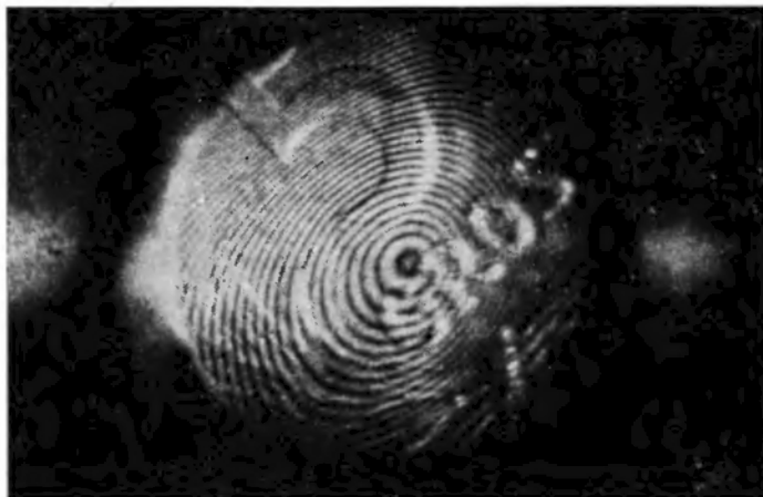
Rys. 2. Interferogram monety umocowanej brzegami w otworze grubej płyty metalowej. Moneta jest centralnie naciskana od tyłu
