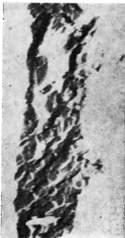
Rys. 10. Rentgenowskie dyfrakcyjne odwzorowanie powierzchni kryształu HgSe o rozwiniętej strukturze blokowej
