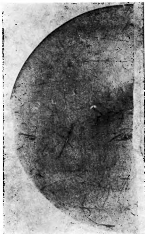
Rys. 13. Rentgenowskie dyfrakcyjne odwzorowanie powierzchni kryształu GaAs o stosunkowo wysokim stopniu perfekcji. Widoczne są tylko rysy powstałe w wyniku polerowania powierzchni
