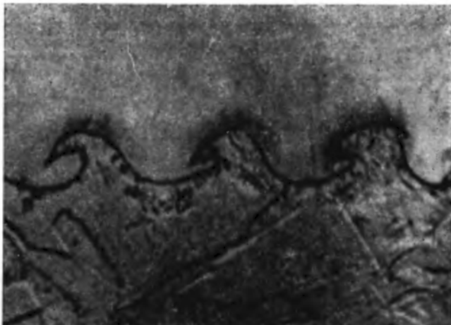
Rys. 4. Złącze Cu-Ni spawane za pomocą fali uderzeniowej (pow. 600 ×)
