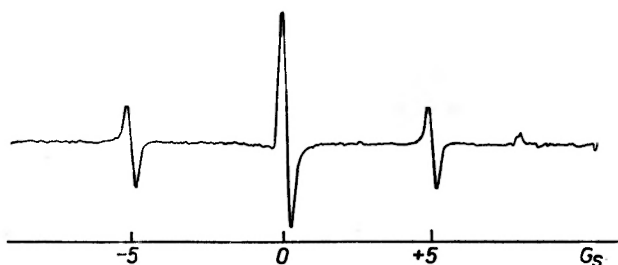
Rys. 3. Sygnały cechujące taśmę rejestratora metodą pasm bocznych odległych od prążka centralnego o 5 Gs
