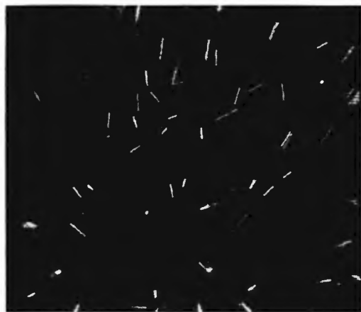
Rys. 14. Fragment rdzenia wielkiego pędu zarejestrowany w łódzkiej komorze śladowej (widok z góry przez elektrodę siatkową)
