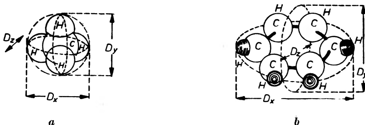
Rys. 2. Przykłady przedstawienia kształtu cząsteczki przy pomocy elipsoidy. a) Elipsoida zbliżona do kuli, opisana na cząsteczce metanu. b) Elipsoida silnie spłaszczona opisana na cząsteczce benzenu
