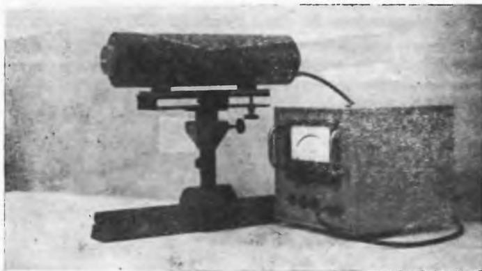
Rys. 1. Widok głowicy i zasilacz lasera He-Ne
