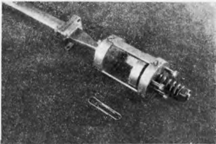
Rys. 15. Rezonator I, otwarty, stosowany jako wnęka spektroskopu
