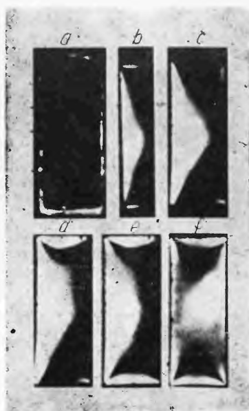
Rys. 6. Obrazy naprężeń w tej samej próbce w różnych stadiach obróbki wg [7]. a. cztery ścianki odcięte piłą diamentową, b. jedna ścianka wypolerowana, c. dwie ścianki wypolerowane, d. trzy ścianki wypolerowane, e. trzy ścianki wypolerowane, przy czym jedna trawiona i polewowana, f. wszystkie ścianki wypolerowane, próbka izotropowa
