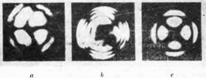
Rys. 5. Obrazy interferencyjne dwójłomności wymuszonej wg [7]. a. płytka o małych naprężeniach, b. płytka o dużych naprężeniach, c. płytka szklana poddana naprężeniom zewnętrznym
