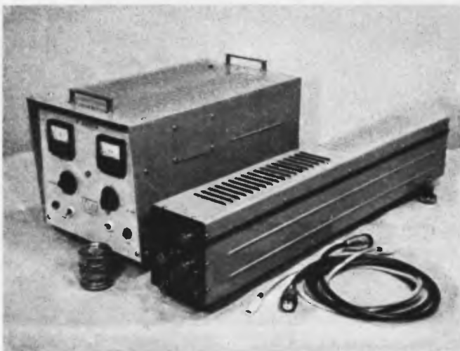
Rys. 1. Laser z rezonatorem długości 800 mm wraz z zasilaczem
