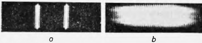
Rys. 8. Obrazy dyfrakcyjno-interferencyjne (doświadczenie Younga) otrzymane na dwóch szczelinach obserwowane w odległości 2 m od szczelin ( a ) oraz w odległości 15 m ( b )
