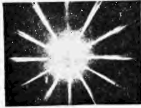
Rys. 10. Wiązka światła lasera czerwonego sfotografowana przy zmniejszonej do minimum 12-segmentowej przesłonie irysowej
