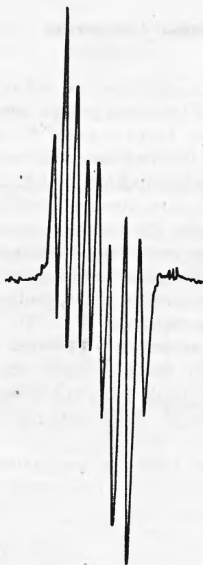
Rys. 19. Widmo ERP kryształu siarczanu trójglicyny, naświetlonego promieniowaniem \gamma kobaltu ^{60}\text{Co}
