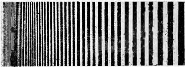
Rys. 3. Test typu Foucaulta o prostokątnym charakterze przepuszczalności
